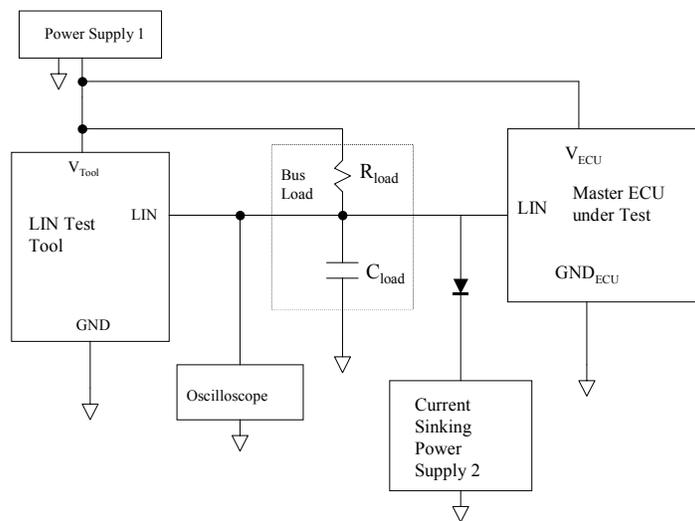
FIGURE 15—MASTER NODE  $V_{ih}$  LEVEL MEASUREMENT TEST SETUP
