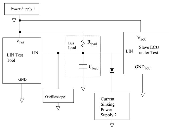
FIGURE 16—SLAVE NODE  $V_{ih}$  LEVEL MEASUREMENT TEST SETUP
