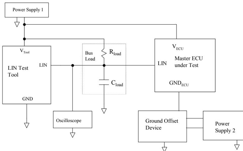
FIGURE 17—MASTER NODE  $V_{ih}$  LEVEL MEASUREMENT TEST SETUP
