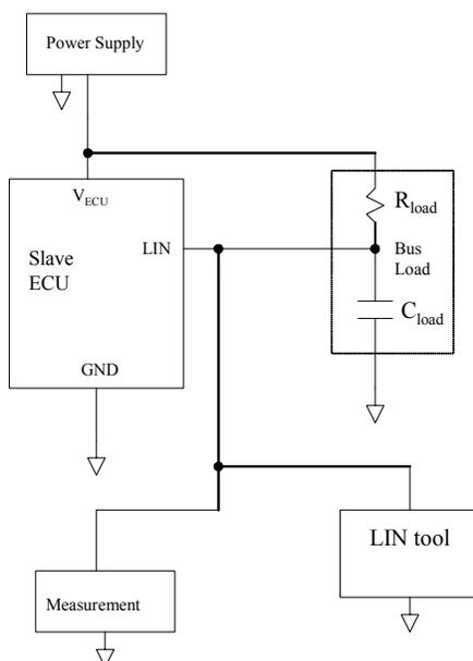
FIGURE 4—SLAVE EXECUTION OF CONFIGURATION TEST SETUP
