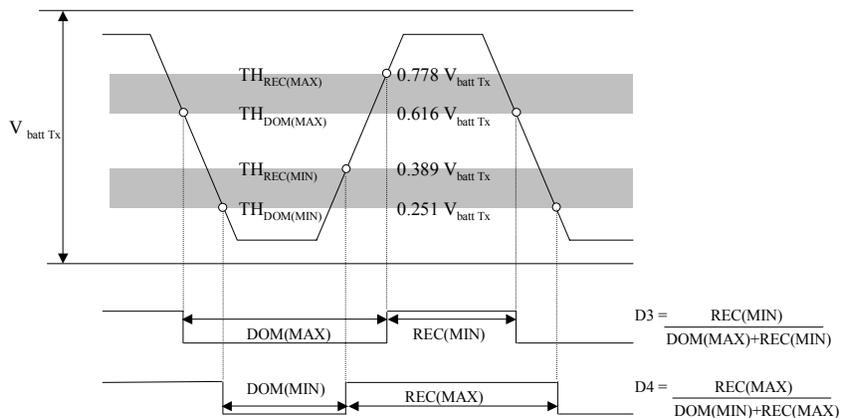
FIGURE 20— $T_{r-d \max}$  AND  $T_{d-r \max}$  MEASUREMENT DESCRIPTION
